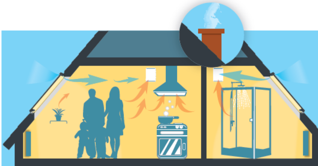
Процес утворення конденсату в приміщенні
